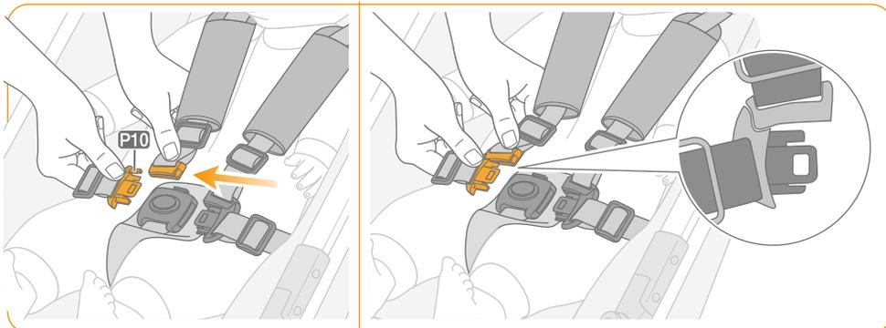
■腰ベルトバックル **P10** を肩ベルトの先端に差し込んでください。
