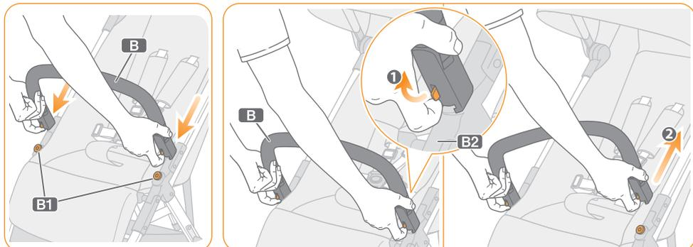
■フロントガード **B** を取り付けるには、固定具 **B1** に上から差し込みます。
