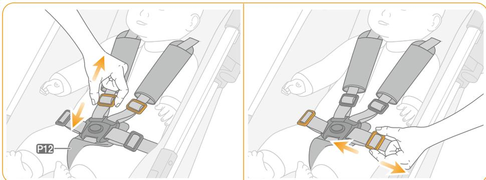
■各ベルトの長さは適切に調整してください。お子様とベルトの間に、大人の指が第2関節まで入るくらいの隙間ができる長さが目安です。
