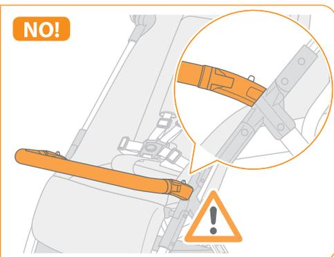
⚠警告 フロントガード **B** の向きが上下逆さまにならないように正しく装着されていることを確認してください。
