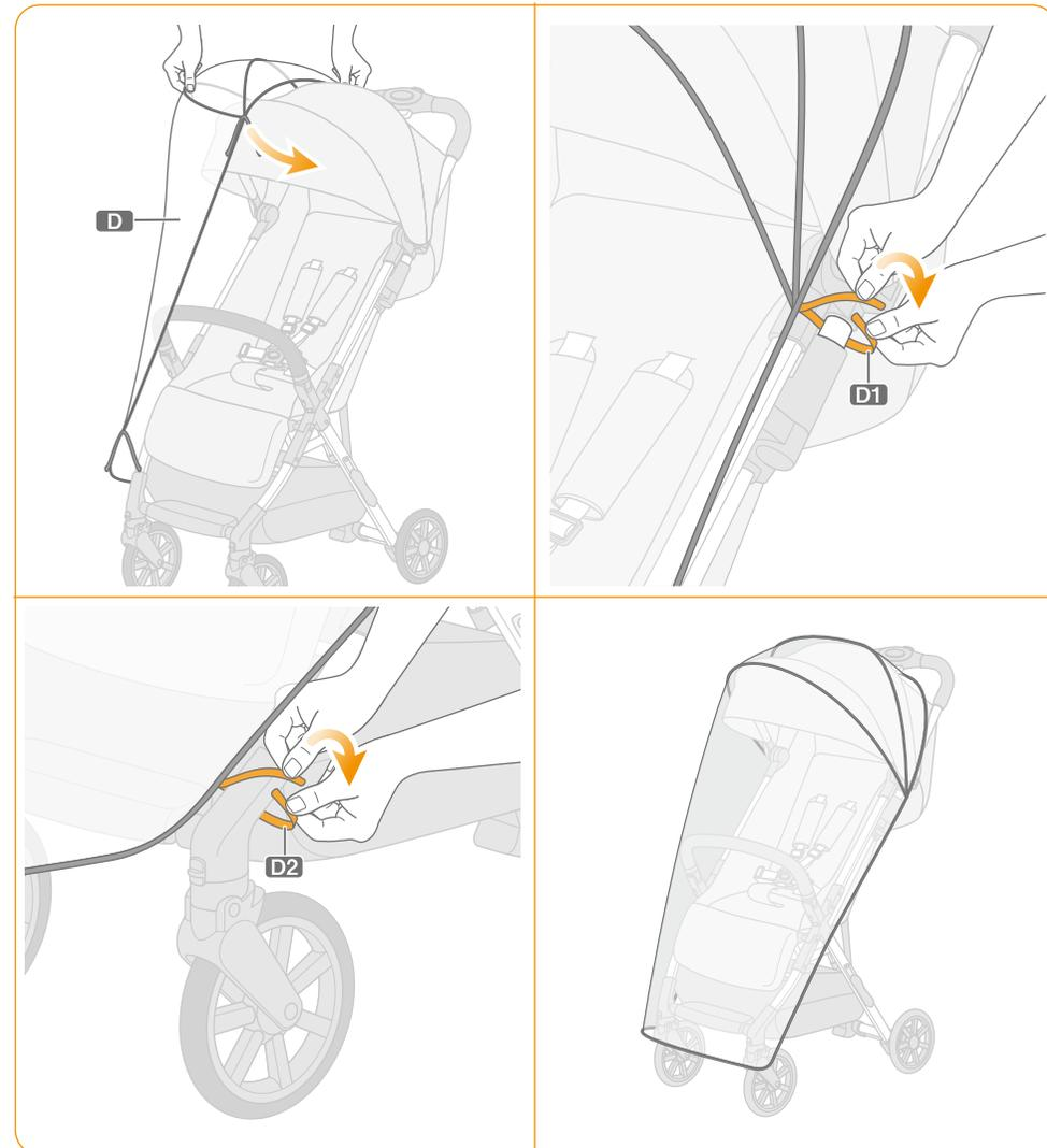
■ ベビーカーを開いた状態で、レインカバー **D** を幌にかけ、面ファスナー **D1** を両サイドのフレームに **D2** を前脚に巻きつけて留めてください。
