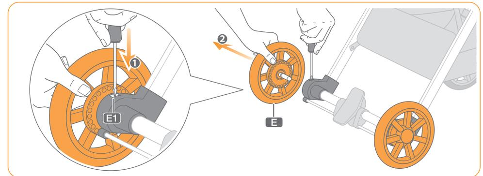
■必要に応じて後輪を外す場合はボタン **E1** をドライバーなどで押しながらか後輪を引き抜くと外れます。
