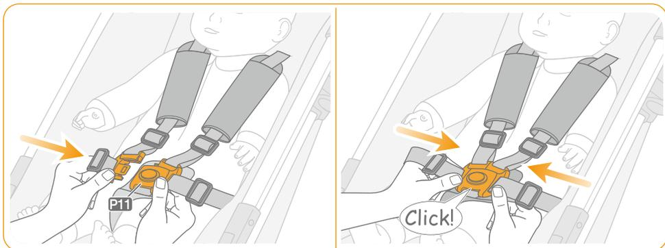
■腰ベルトバックルを股ベルトバックルにカチッと音がするまで確実に差し込んでください。
