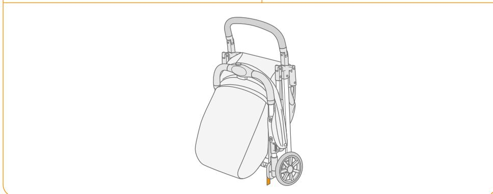
■出荷時にはベビーカー自立用のサポートパーツが収納された状態になっています。ご使用前に、フレームの内側にあるサポートパーツ **S1** の先端を①外側に強く押し、②根本の回転部を浮かせて図のように回転させて固定してください。一度固定したら、その後は収納する必要はありません
