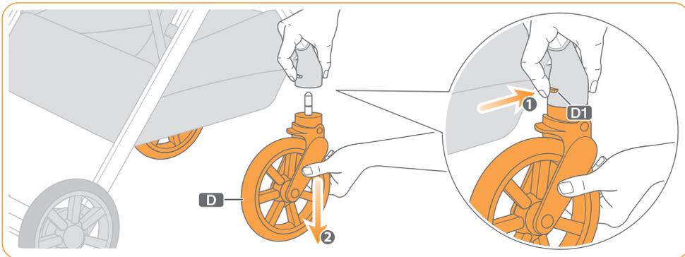
■必要に応じて前輪を外す場合は、ボタン **D1** を押したまま前輪 **D** を引き抜くと外れます。
