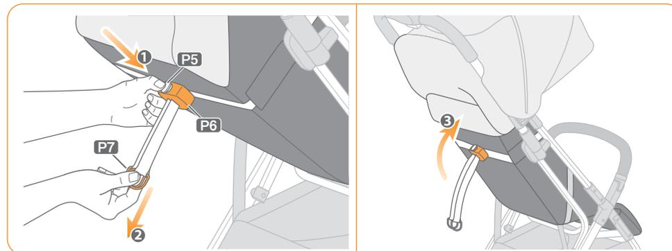
■リクライニングを起こす場合は、シート後ろ側にあるリクライニングアジャスター **P6** にあるボタン **P5** を押しながら、ベルトの先端にあるリング **P7** を下に引っ張ってください。
