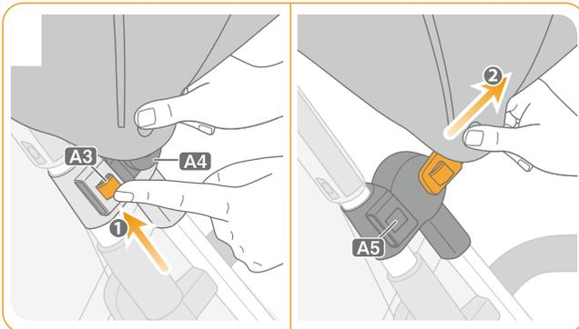
■ 幌ジョイント **A4** にあるボタン **A3** を押しながらフレーム部 **A5** から引き抜きます。
