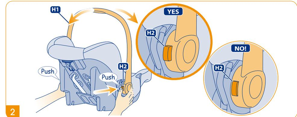
■ハンドル(H1)を調節するには、左右のボタン(H2)を同時に押し、希望の位置まで回します。ハンドルを希望の位置にした後は、左右のボタン(H2)が完全に飛び出していることを確認してください。
